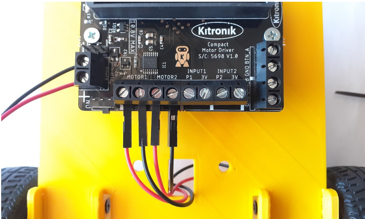
Figuur 21: Aansluiting van de twee DC-reductiemotoren op de Compact-motordriver
