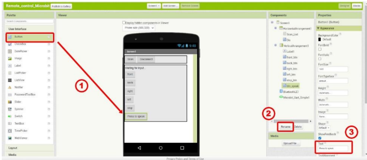
Figuur 19: Een nieuwe knop toevoegen (1) en hernoemen naar btn_speak (2), terwijl de tekst wordt gewijzigd in Druk om te spreken (3)
